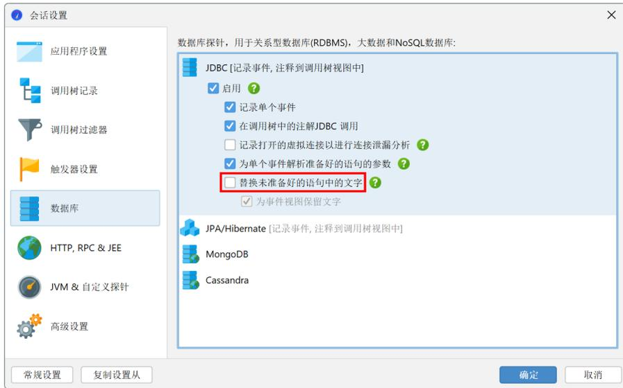
另一方面，JProfiler 收集预处理语句的参数，并在事件视图中显示完整的 SQL 字符串而不带占位符。同样，这在调试时很有用，但如果您不需要它，可以在探针设置中关闭它以节省内存。
