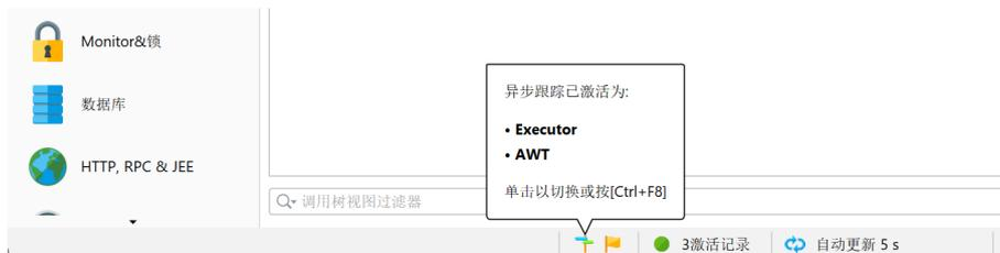
JProfiler检测到在被分析的JVM中使用了未激活的异步请求跟踪类型，并在状态栏中的异步和远程请求跟踪图标旁边显示一个💡通知图标。通过单击通知图标，您可以激活检测到的跟踪类型。异步和远程请求跟踪可能会产生大量开销，只有在必要时才应激活。
