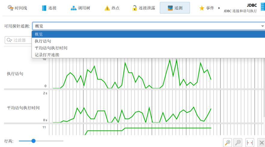
热点视图和控制对象视图显示累积数据，这些数据可能在一段时间内跟踪很有趣。这些特殊的遥测由探针跟踪器记录。设置跟踪的最简单方法是从热点或控制对象视图中使用添加选择到跟踪器操作添加新的遥测。在这两种情况下，您都必须选择是要跟踪时间还是计数。当跟踪控制对象时，遥测是所有不同探针事件类型的堆叠区域图。对于跟踪的热点，跟踪的时间被分成不同的线程状态。
