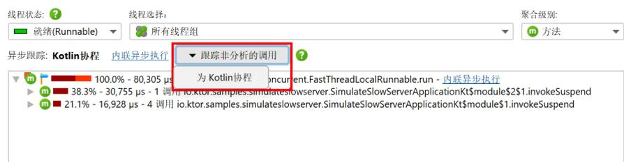
重要的是要理解，Kotlin协程只能在其启动时CPU记录处于活动状态时进行跟踪。如果您稍后开始CPU记录，Kotlin协程的异步执行将无法内联。JProfiler会像检测未分析类中的调用点一样通知您。如果您需要分析在应用程序开始时启动的长寿命协程，则使用附加模式不是一个选项。在这种情况下，使用-agentpath VM参数 [p. 11] 启动JVM，并在启动时开始CPU记录。
