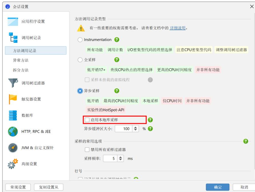
JProfiler解析属于每个本机栈帧的库路径。在调用树中的本机方法节点上，JProfiler在开头以方括号显示本机库的文件名。
