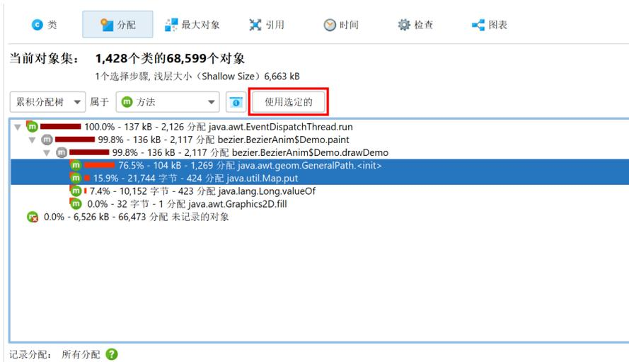
与类视图一样，您可以选择多个节点，并使用顶部的 Use Selected 按钮创建新的选择步骤。在“Allocation hotspots”视图模式中，您还可以选择回溯中的节点。这将仅选择在关联的顶级热点上分配的对象，这些对象的调用栈以所选回溯结束。
