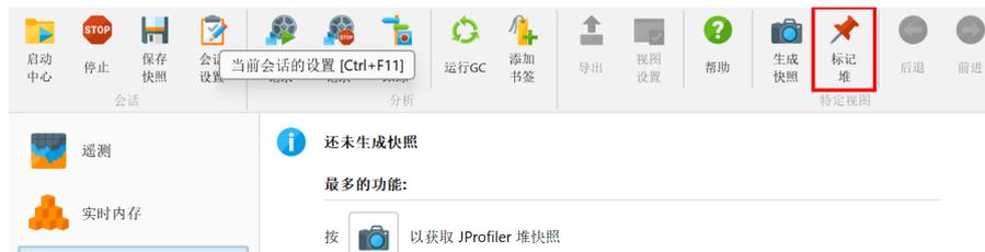
隔离您感兴趣的对象集的另一种方法是通过分配记录。当拍摄堆快照时，您可以选择显示所有记录的对象。然而，您可能不希望将分配记录仅限于特定用例。此外，分配记录的开销很高，因此标记堆操作的影响相对较小。最后，堆漫游器允许您在任何选择步骤中使用使用新和使用旧超链接选择旧对象和新对象。
