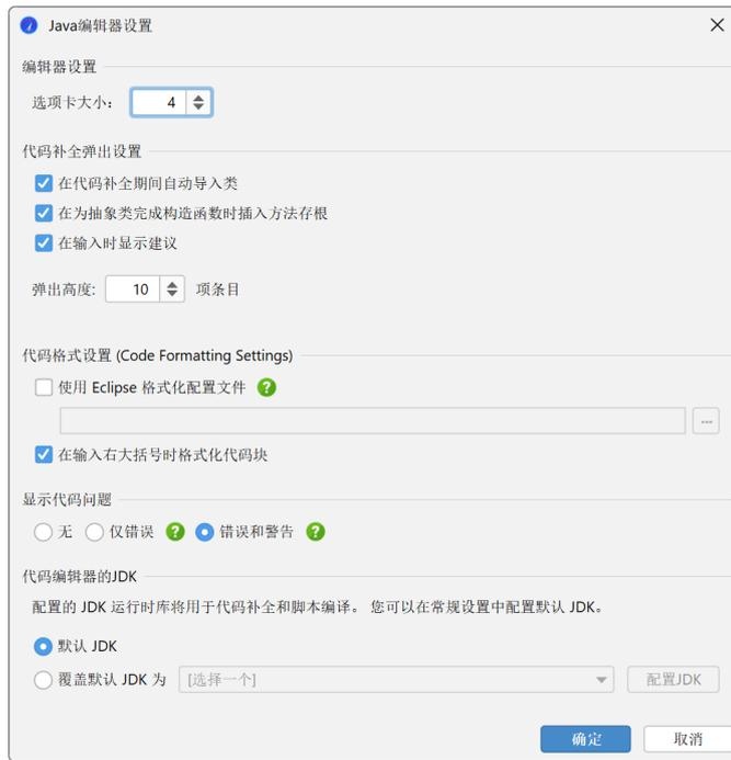
如果对话框右上角的边列图标是绿色的，那么你的脚本将被编译，除非你在编辑器设置中禁用了错误分析。在某些情况下，你可能想尝试真正的编译。选择菜单中的代码->测试编译将编译该脚本并在一个单独的对话框中显示任何错误。在保存脚本时使用 好的 按钮不会测试脚本的语法正确性，除非马上使用该脚本。
