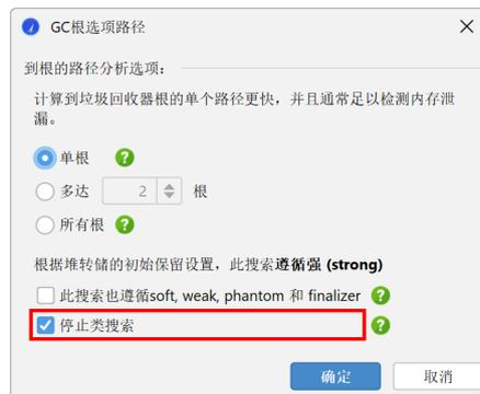
如果您在解释到GC根的最短路径时遇到问题，可以搜索其他路径。一般来说，不建议搜索到GC根的所有路径，因为它可能会产生大量路径。
