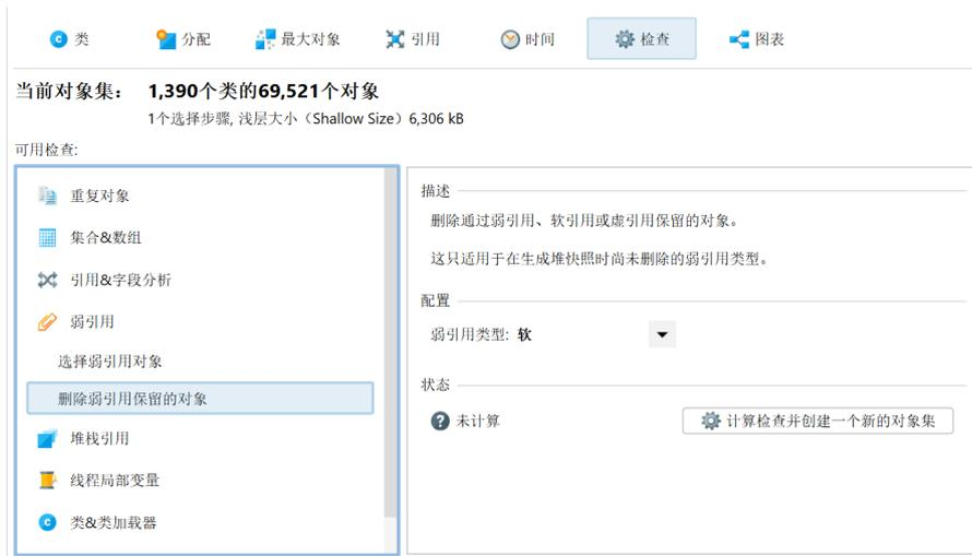
在搜索到GC根的路径时，堆漫游器选项对话框中选择的保留对象的引用类型会被考虑在内。这样，路径到GC根搜索始终可以解释为什么对象在堆漫游器中被保留。在路径到GC根搜索的选项对话框中，您可以将可接受的引用类型扩展到所有弱引用。
