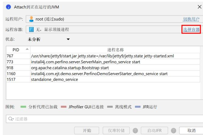
リモートアタッチダイアログのSelect containerハイパーリンクを使用して、実行中のDockerコンテナを選択し、その中で実行されているすべてのJVMを表示できます。
