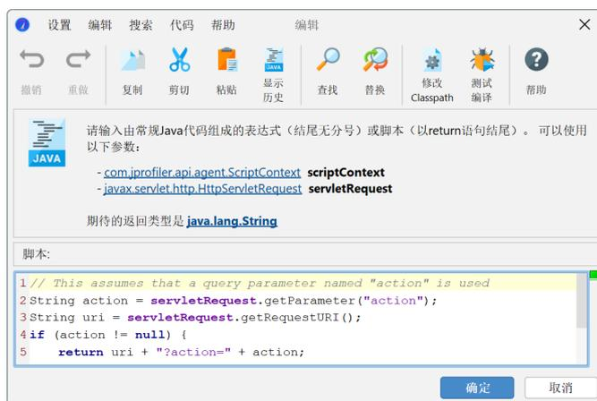
编辑区上方的方框显示了脚本的可用参数以及它的返回类型。通过调用菜单中的帮助->显示Javadoc概述，你可以获得 com.jprofiler.api.\* 包中类的更多详情。
