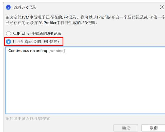
您现在可以选择在JProfiler中启动新记录或转储现有记录并在JProfiler中显示生成的JFR快照。外部启动的JFR记录具有独立的生命周期，不会被JProfiler停止。
