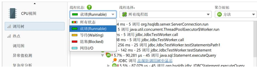
如果您对挂钟时间感兴趣，您必须选择线程状态“所有状态”并选择单个线程。只有这样，您才能将时间与您在代码中通过调用 `System.currentTimeMillis()` 计算的持续时间进行比较。
